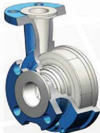
非金属衬塑磁力泵采用球墨铸铁外壳，衬塑泵壳是一个整体，由模具挤压成型并带有平面法兰，PFA材料最小厚度5毫米
